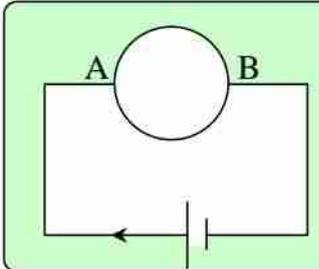
هـ) شكل سلك مقاومته  $48 \Omega$  على شكل حلقة مغلقة ثم وصلت بطارية بين طرفي قطر الحلقة كما بالشكل، فإن المقاومة المكافئة بين النقطتين A, B .....
