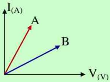
الرسم المقابل يوضح العلاقة بين فرق الجهد وشدة التيار الكهربائي لموصلين (B, A) من نفس المادة ولهما نفس الطول عند ثبوت درجة الحرارة أوجد:
