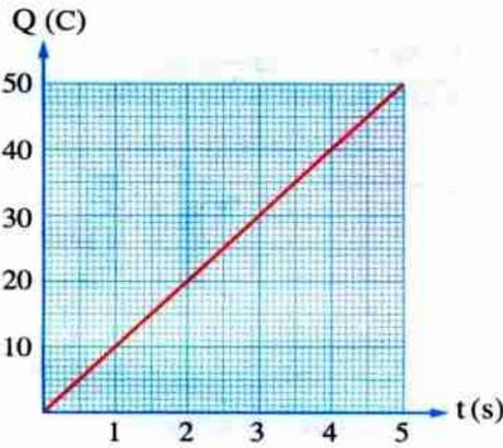
٢) الرسم البياني المقابل يمثل العلاقة بين كمية الشحنة الكهربائية (Q) المارة عبر مقطع من موصل في دائرة تيار مستمر (t)، فتكون قيمة شدة التيار المستمر هي .....
