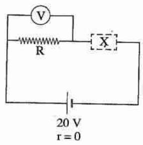
٤) الشكل المقابل يمثل دائرة كهربائية مغلقة فاي من المكونات الآتية يمثل العنصر X الذي يجعل مؤشر الفولتميتر ينحرف إلى 4 V
