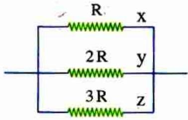
١) الرسم المقابل يوضح ثلاث مقاومات X, Y, Z متصلة معاً على التوازي، فأي من الأشكال التالية يمثل نسب شدة التيار بكل منها؟ .....
