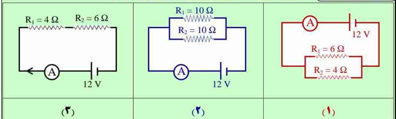
اكتب رقم الدائرة التي: (١) تختلف فيها شدة التيار في المقاومتين.
